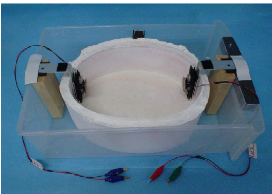
図2：水中超音波伝搬減衰測定（放射状に広がる）
